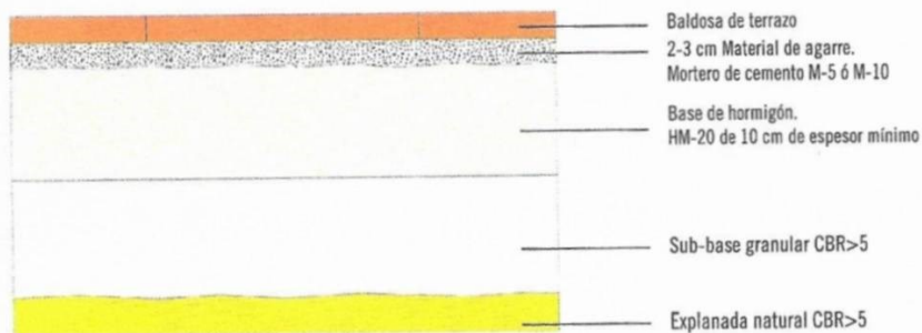
E1 con sub-base granular.
